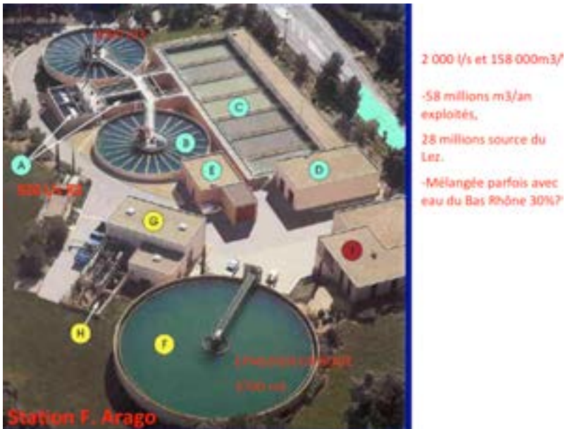
Figure 8 : Vue aérienne de la station Arago avec ses bacs à décantation de boue et piscines de clarification. Document Agglomération Montpellier.
